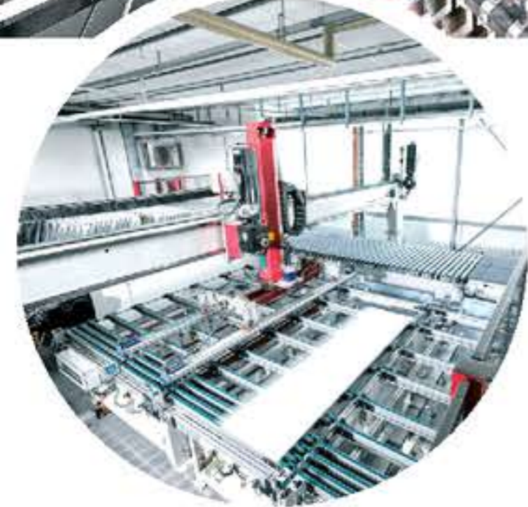
Oben: Für die individuelle Gestaltung der Küchen hält das Kantenmagazin eine Vielzahl von Kantenmaterialien vor. Darunter: Mit der Rückführungsstrecke (hinten) ist eine vollständige automatische Bekantung der Werkstücke möglich.
